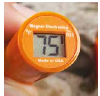
Der RH-Test (relative Betonluftfeuchte)
